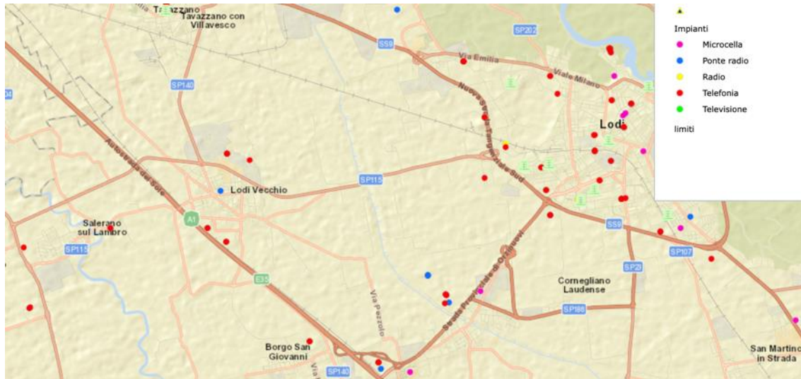
figura 11-5 distribuzione delle sorgenti a radiofrequenza - dati estratti dal Catasto Informatizzato degli Impianti di ARPA (CASTEL) 2017
